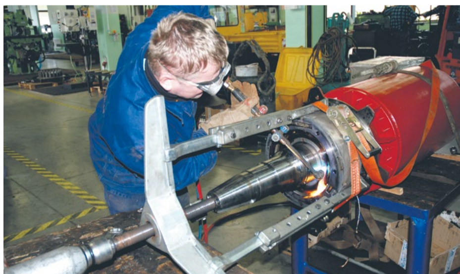
Pracownicy warsztatów ZWiK często naprawiają pompy uszkodzone przez przedmioty, które nie powinny trafiać do sieci sanitarnej.
