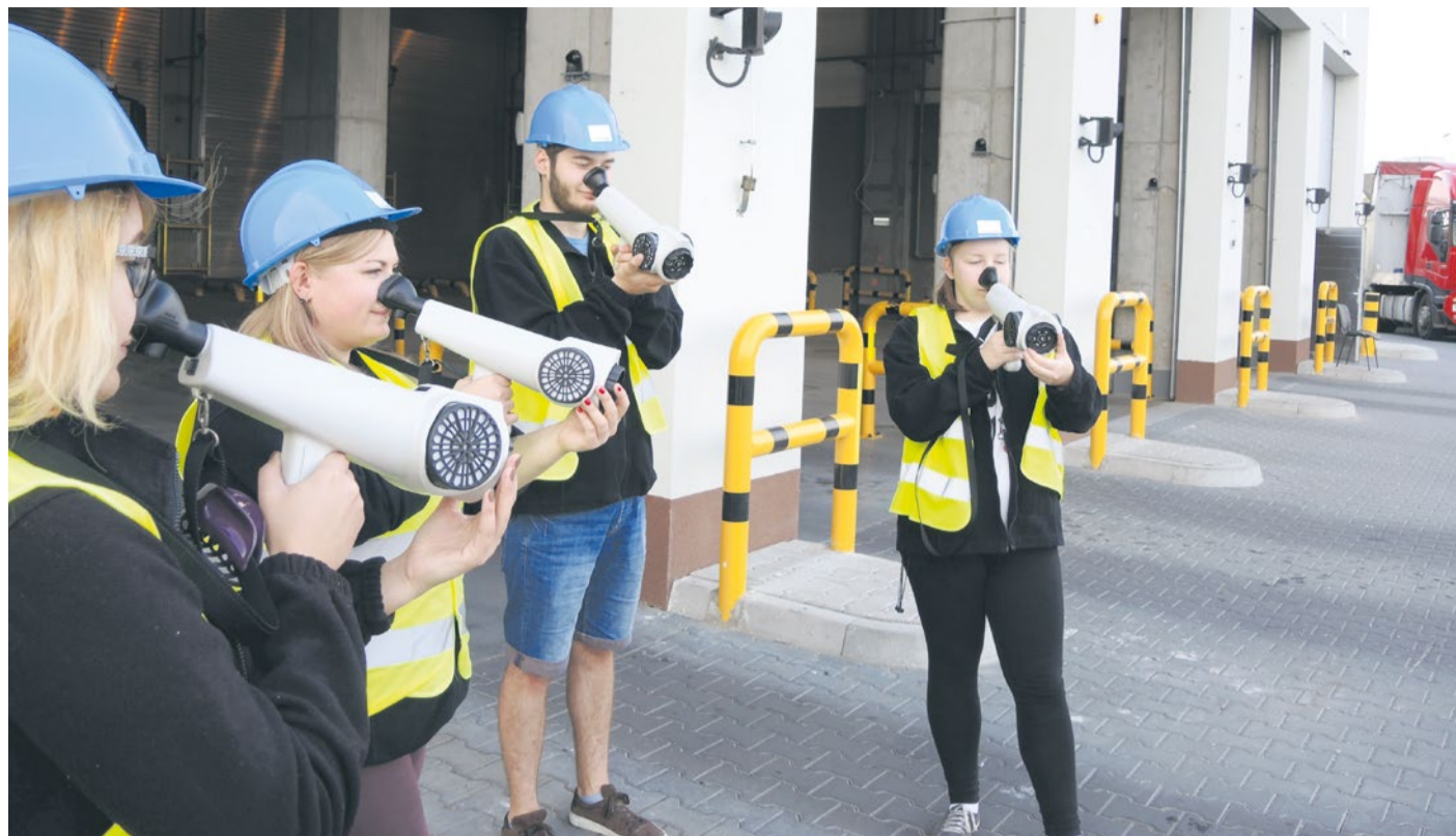
Paula, Aleksandra, Filip i Dominika – studenci z Koła Zapachowej Jakości Powietrza – przy użyciu olfaktometrów badają stan powietrza przed halą wyładunkową EcoGeneratora
